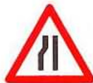
1.09 Chaussée rétrécie à gauche.
